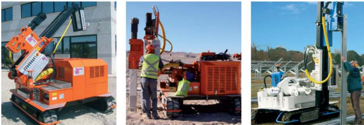
Εικόνα 10: Μηχάνημα τοποθέτησης πασσάλων
